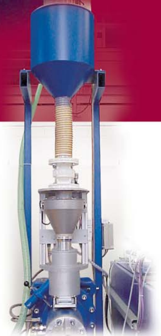
Gravimetrische Dosierung für exakte Metergewichtsvorgabe
