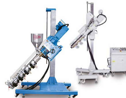
Universalständer für horizontalen und vertikalen Einsatz Universal mounting stand for horizontal and vertical operation
