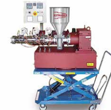
Beispritzextruder auf Scherenhubtisch, drehbar um 360°
