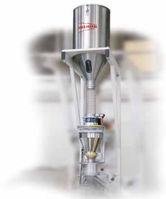
Gravimetrische Wiege- und Dosiereinrichtung auf dem Hauptextruder Gravimetric weighing and metering station on main extruder
