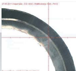
3-Schichtrohr für den Automotivbereich aus PA 12 3-layer PA 12 pipe for automotive applications
