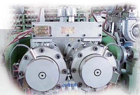
Doppelstrangrohrkopf für PPR-Monorohre Twin die head for PPR monolayer pipes
