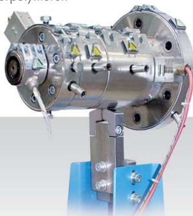
Rohrkopf RW 040 auf Werkzeugaufnahmewagen RW 040 pipe die head on tooling-support trolley
