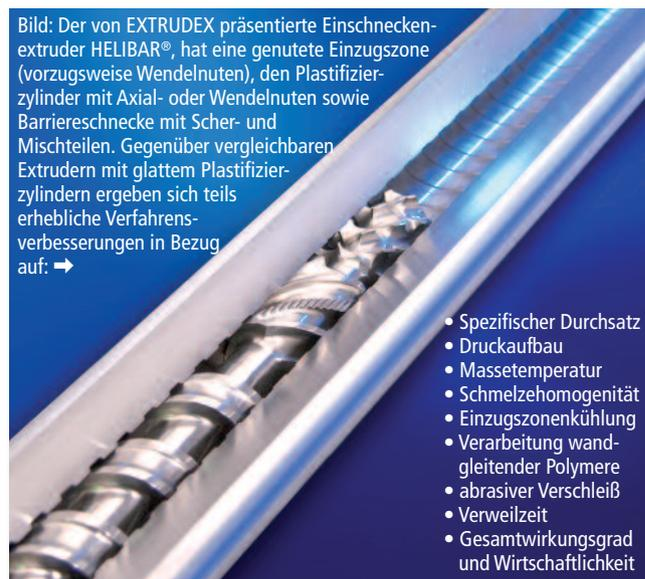
**Bild:** Der von EXTRUDEX präsentierte Einschneckenextruder HELIBAR®, hat eine genutete Einzugszone (vorzugsweise Wendelnuten), den Plastifizierzylinder mit Axial- oder Wendelnuten sowie Barrierschnecke mit Scher- und Mischteilen. Gegenüber vergleichbaren Extrudern mit glattem Plastifizierzylindern ergeben sich teils erhebliche Verfahrensverbesserungen in Bezug auf: →
