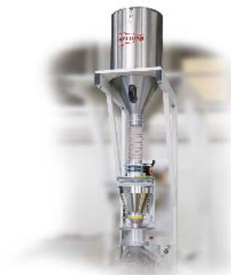
Gravimetrische Wiege- und Dosiereinrichtung auf dem Hauptextruder Gravimetric weighing and metering station on main extruder
