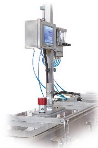
Vollautomatische Vakuumregelung EVS (Efficient Vacuum System) EVS (Efficient Vacuum System) closed-loop vacuum control module
