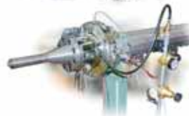
管头 适用于生产 PVDF (聚偏氟乙烯) 波形管
