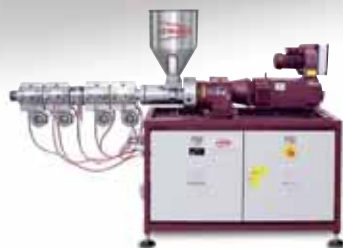
EN 30 实验室挤出机 3个可选工艺单元
