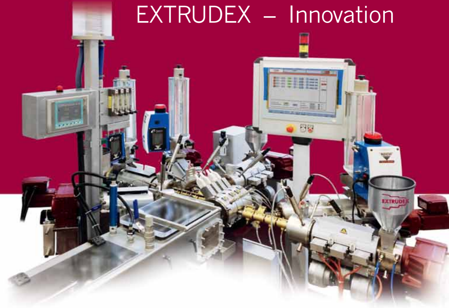
Weltweit erste 3-6-Schicht-Extrusionslinie zur Herstellung von 3- bis 6-Schichtschläuchen mit einer Gesamtwandstärke von 0,275 mm
