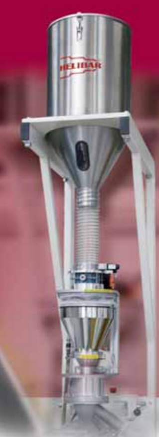
Gravimetrische Wiege- und Dosiereinrichtung auf dem Hauptextruder Gravimetric weighing and metering station on main extruder
