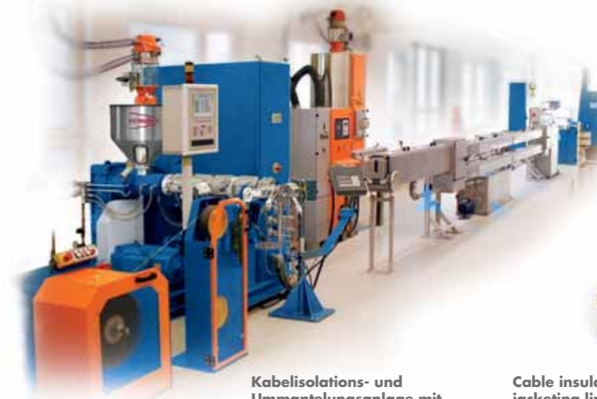
Leiterquerschnitte: 0,75–2,5 mm Kabeldurchmesser: 2,0–5,5 mm Anlagengeschwindigkeit: 600 m/min
