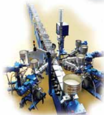
Mehrschicht-Extrusionsanlage zur Herstellung von 5-Schicht-Fußbodenheizungsrohren von 8 - 32 mm Außendurchmesser
