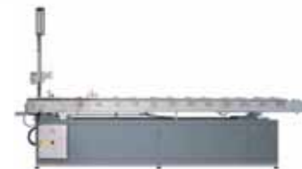
Vakuum-Kalibrierbad Typ VB300, VB600 zum Kühlen und Kalibrieren von Rohren
