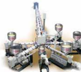
6-Schicht-Extrusionsanlage zur Fertigung von 6-Schichtrohren für die Automobilindustrie von 4 - 18 mm Außendurchmesser
