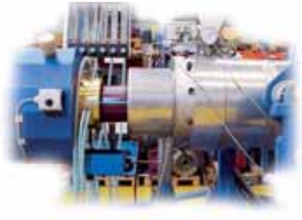
Extrusionslinie zur Herstellung von PE- u. PP-Rohren bis max. 160 mm Außendurchmesser und Druckstufen bis PN 20
