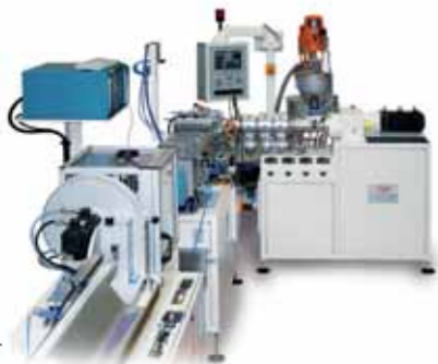
Extrusionslinie zur Herstellung mehrlumiger Medizinschläuche aus TPU, PUR, PA, PEBAX von 0,8 bis 8 mm Außendurchmesser
