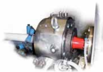
Anlage zur Ummantelung eines PE-Schaumschlauches mit einer LDPE-Folie
