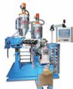
2-Schicht-Wellrohr- Kabelschutzanlage zur Herstellung von 2-schichtigen Kabelschutz-Wellrohren
