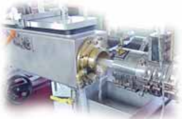
Extrusionslinie zur Herstellung von medizinischen Weich-PVC- Schläuchen von 2 bis 12 mm Außendurchmesser
