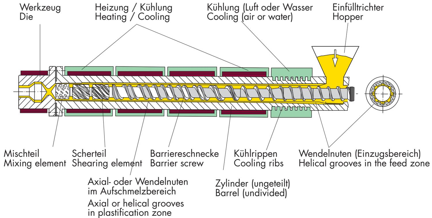
Prinzip eines Einschneckenextruders mit genutetem Plastifizierzylinder und Barrierschnecke mit Scher- und Mischteilen
